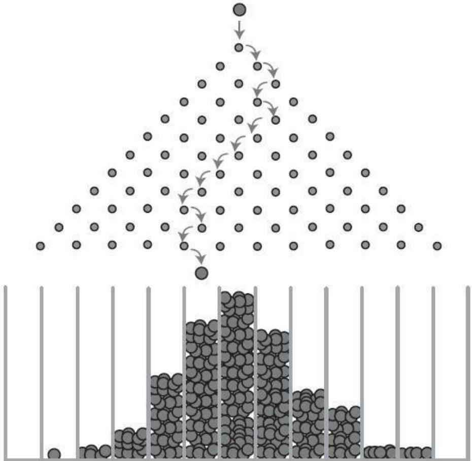
**Эксперимент с доской Гальтона.** Правильное расположение шариков (симметричное, при котором в центральных гнездах их много, а в крайних мало) повторяется от эксперимента к эксперименту. Это свидетельствует о существовании объективного закона их распределения.
