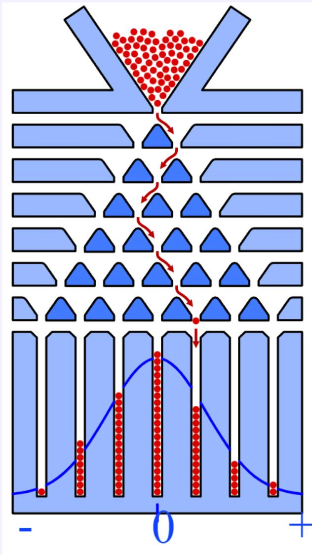
**Доска Гальтона** — устройство, изобретённое английским учёным Фрэнсисом Гальтоном (первый экземпляр изготовлен в 1873 году, затем устройство было описано Гальтоном в книге *Natural inheritance*, изданной в 1889 году) и предназначающееся для демонстрации центральной предельной теоремы.
